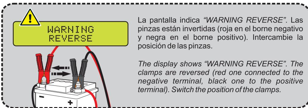
La pantalla indica “WARNING REVERSE”. Las pinzas están invertidas (roja en el borne negativo y negra en el borne positivo). Intercambie la posición de las pinzas.
