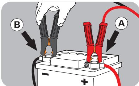
Conecte las pinzas a la batería siguiendo este orden: primero la pinza roja al borne positivo + (A) y después la pinza negra al borne negativo - (B).
