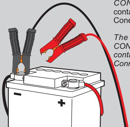
La pantalla indica “¡ATENCIÓN! FALSO CONTACTO”. Las pinzas no hacen buen contacto o no están conectadas a la batería. Conecte correctamente las pinzas a la batería.
