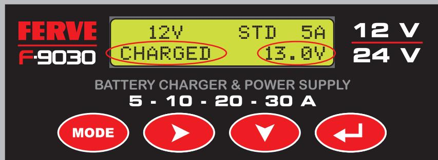
Final de carga. La batería está totalmente cargada cuando la pantalla indica “CARGADA” y la tensión de la batería. Si lo deja conectado, el F-9030 mantendrá la batería al 100% (solo para baterías de plomo-ácido: líquidas, Gel, AGM y EFB).
