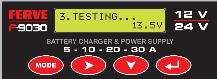
La pantalla indica “PROBANDO...” y la tensión de la batería. Si la tensión de la batería es 0, asegúrese de que las pinzas están bien conectadas. Arranque el vehículo y manténgalo a 2000 rpm durante 2 minutos.
