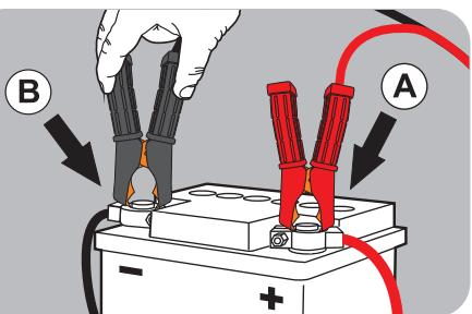
Conecte las pinzas a la batería siguiendo este orden: primero la pinza roja al borne positivo + (A) y después la pinza negra al borne negativo - (B).
