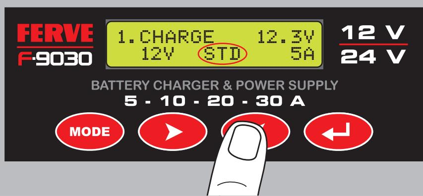
Seleccione el tipo de la batería a cargar: STD (batería estándar), EFB, LFP (litio), AGM o GEL. Pulse y después para escoger el tipo de batería.
