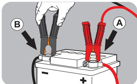
Conecte las pinzas a la batería siguiendo este orden: primero la pinza roja al borne positivo + (A) y después la pinza negra al borne negativo - (B).
