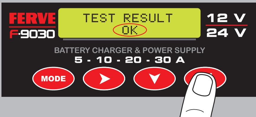
Pulse **◀** para iniciar la prueba. Si la pantalla indica “OK”, el alternador funciona correctamente ya que la lectura está entre 13,3 V y 15,5 V. Si indica “NO OK”, la carga del alternador no es correcta y la lectura está por debajo de 13,3 V o es superior a 15,5 V.
