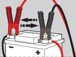
La pantalla indica “PINZAS INVERTIDAS”. La pinza roja está en el borne negativo y la negra en el borne positivo. Intercambie la posición de las pinzas.
