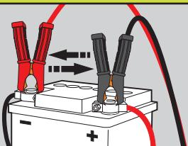
La pantalla indica “PINZAS INVERTIDAS”. La pinza roja está en el borne negativo y la negra en el borne positivo. Intercambie la posición de las pinzas.
