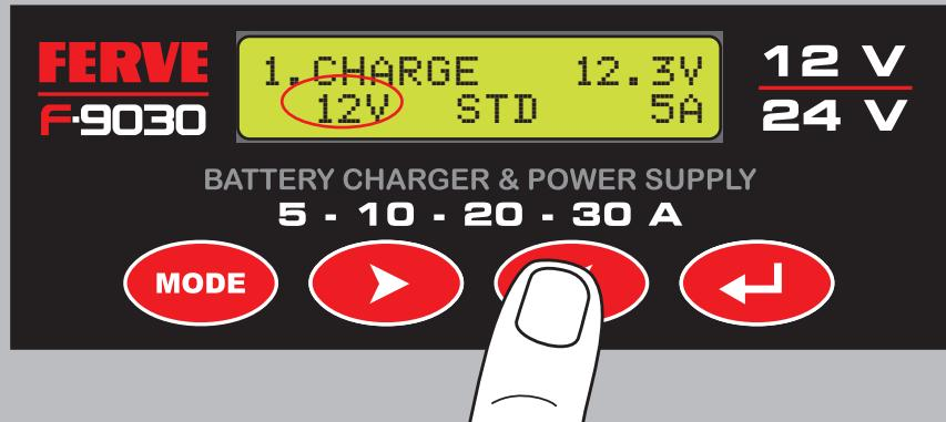
Seleccione la tensión de la batería a cargar: 12 o 24 V.
