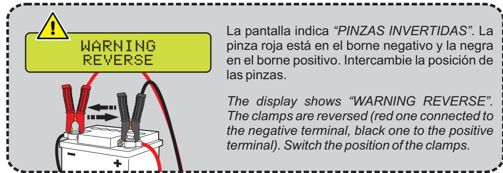
La pantalla indica “PINZAS INVERTIDAS”. La pinza roja está en el borne negativo y la negra en el borne positivo. Intercambie la posición de las pinzas.
