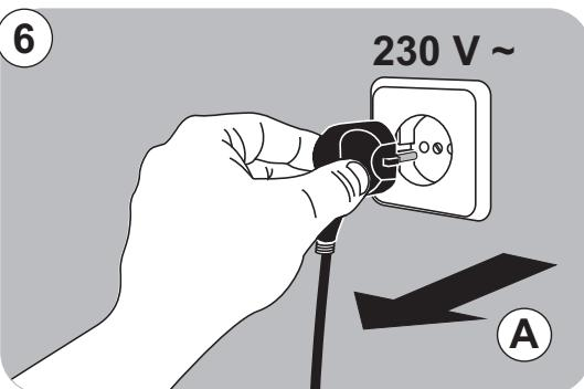
Desconecte el cargador de la red (A), a continuación retire la pinza negra (B) y finalmente la pinza roja (C).
