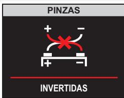
La pantalla indica “INVERTIDAS”. Las pinzas están invertidas (roja en el borne negativo y negra en el borne positivo). Intercambie la posición de las pinzas.
