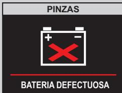
La pantalla indica "BATERIA DEFECTUOSA". Sustituya la batería.
