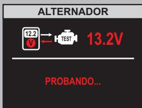
La pantalla indica “PROBANDO...” y la tensión de la batería. **Si la tensión de la batería es 0, asegúrese de que las pinzas están bien conectadas.** Arranque el vehículo y manténgalo a 2000 rpm durante 3 minutos.
