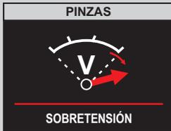
La pantalla indica "SOBRETENSIÓN". La batería está por encima de 16V. Asegúrese de que la batería es de 12V para utilizar este modo.
