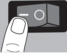
Conecte el F-9100 pulsando el conmutador “- O” de la parte trasera, colóquelo en la posición “-”.
