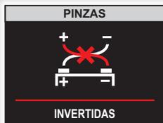
La pantalla indica “INVERTIDAS”. Las pinzas están invertidas (roja en el borne negativo y negra en el borne positivo). Intercambie la posición de las pinzas.
