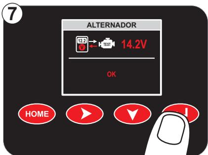
Si la pantalla indica “OK”, el alternador funciona correctamente ya que la lectura está entre 13,3 V y 15,5 V. Si indica “NO OK”, la carga del alternador no es correcta y la lectura está por debajo de 13,3 V o es superior a 15,5 V.
